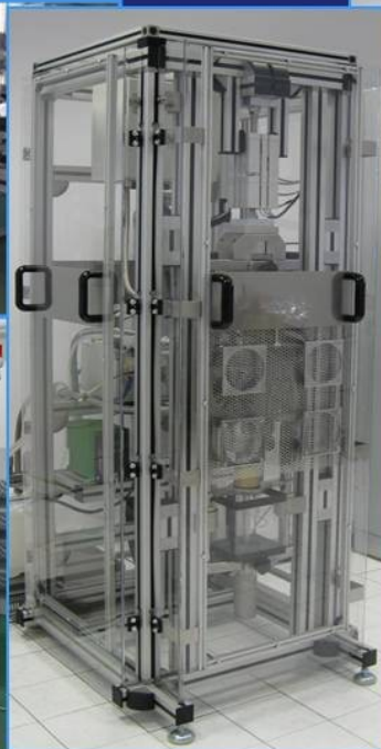
Urządzenie do mikrofalowej hydro- i solvo- termalnej syntezy nanoproszków
